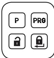
Las funciones del automatismo de cerradura de puerta se pueden ajustar mediante la tecla **P** y la tecla **PRG** del campo de sensores. Cada función dispone de diferentes parámetros que permiten ajustes adicionales. Antes de la puesta en marcha, todos los parámetros están en la posición de ajuste de fábrica. Solo se autoriza la modificación de las funciones cuando el automatismo está en reposo.
