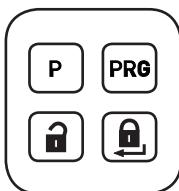
Le funzioni della motorizzazione serratura sono regolabili con i tasti **P** e **PRG** del pannello di controllo. Ogni funzione dispone di più parametri che consentono ulteriori impostazioni. Prima della prima messa in funzione tutti i parametri si trovano sull'impostazione di fabbrica.
