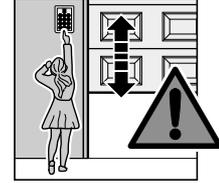
Vær opmærksom på, at disse er placeret udenfor børns rækkevidde! Der skal anbringes advarselsskilte, som gør opmærksom på faren for at blive klemt inde, skiltene skal anbringes et iøjnefaldende sted eller i umiddelbar nærhed af føleren, som styrer portautomatikken.
