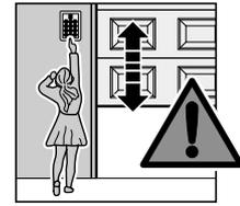
Waarschuwbordjes tegen vastklemmen moeten permanent worden aangebracht op een opvallende plaats of in de nabijheid van een vast geïnstalleerde bediening voor de aandrijving. Het plafond van de garage moet stevig genoeg zijn om een veilige bevestiging van de aandrijving te verzekeren.
