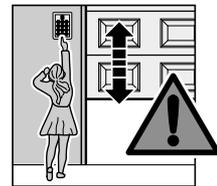
Ο μηχανισμός κίνησης της πόρτας έχει σχεδιαστεί για να λειτουργεί σε στεγανούς χώρους και ως εκ τούτου δεν πρέπει να εγκατασταθεί σε ανοιχτό χώρο.
