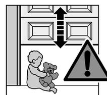
Se ha de prestar atención a que no se encuentren personas ni objetos en la zona de movimiento de la puerta. Las primeras pruebas de funcionamiento, así como la programación o la ampliación del mando a distancia deberían realizarse siempre en el interior del garaje.
